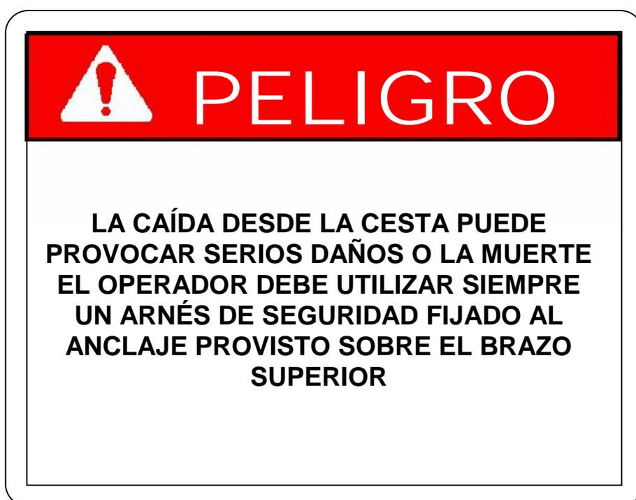
CALCO DE ANCLAJE DE ARNES (1 en la zona de anclaje sobre el brazo superior)
