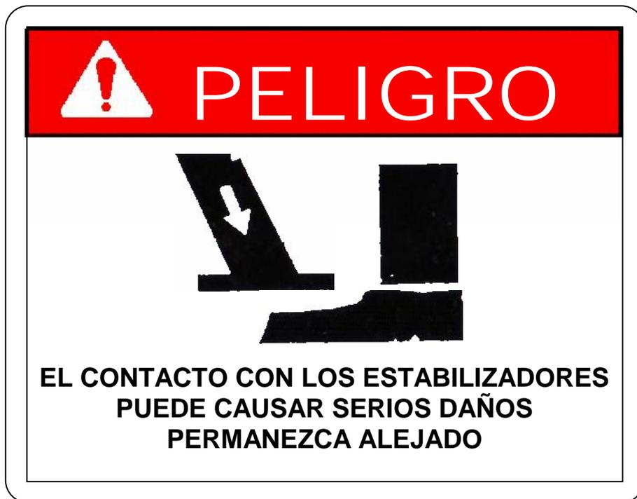
CALCO DE PROHIBICIÓN DE USO DE LA UNIDAD SIN APOYAR LOS ESTABILIZADORES (1 en la zona de comando de estabilizadores)
